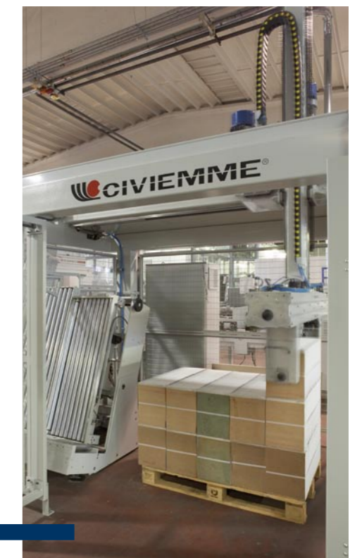
I pacchi compressi e reggiati vengono trasportati dallo stacker al palettizzatore PL 86 ad esso direttamente collegato che, con la sua pinza pneumatica, preleva i pacchi dalla tavola di uscita e li posiziona con precisione sul pallet. La possibilità di rotazione del pacco di 90°, 180° o 270° permette di utilizzare completamente lo spazio disponibile sul pallet ed evita la necessità di ulteriori rotazioni del pacco in legatoria.
