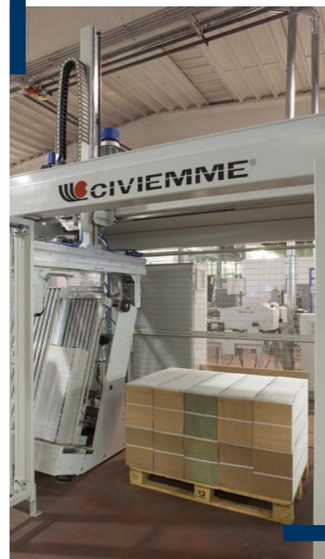
I pacchi compressi e reggiati vengono trasportati dallo stacker al palettizzatore PL 86 ad esso direttamente collegato che, con la sua pinza pneumatica, preleva i pacchi dalla tavola di uscita e li posiziona con precisione sul pallet. La possibilità di rotazione del pacco di 90°, 180° o 270° permette di utilizzare completamente lo spazio disponibile sul pallet ed evita la necessità di ulteriori rotazioni del pacco in legatoria.
