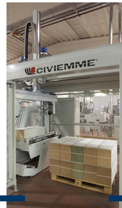
I pacchi compressi e reggiati vengono trasportati dallo stacker al palettizzatore PL 86 ad esso direttamente collegato che, con la sua pinza pneumatica, preleva i pacchi dalla tavola di uscita e li posiziona con precisione sul pallet. La possibilità di rotazione del pacco di 90°, 180° o 270° permette di utilizzare completamente lo spazio disponibile sul pallet ed evita la necessità di ulteriori rotazioni del pacco in legatoria.
