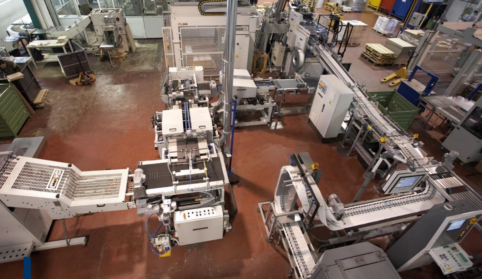
Vista completa del sistema di finishing collegato alle due uscite piega della rotativa Komori System 38D. Dopo essere passato attraverso il sistema centrale di espulsione scarti, il flusso combinato dei prodotti provenienti dalle uscite A4 e A3 può essere trasportato ad uno stacker compensatore con possibilità di rifilo su tre lati in una linea di rifilo RS 830 o allo stacker a pacco ST 420.
