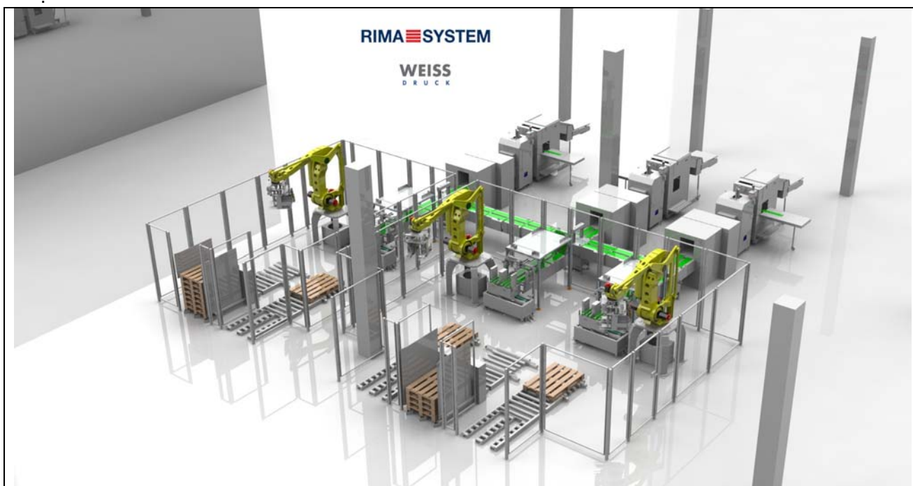
Area di impilaggio e palettizzazione ad alta paginazione e ad alta velocità completamente automatizzata di Weiss-Druck.
