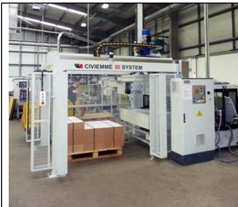
La rotativa M600 è stata collegata ad una linea completa di taglio e impilaggio, ad uno stacker a pacco RS 610 e ad un palettizzatore PL86.
