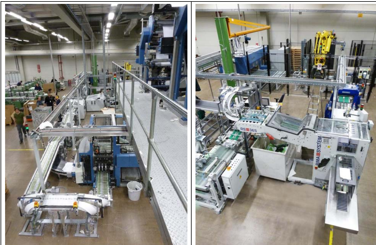
Utilizzando gli speciali convogliatori a spirale, a S e a C, l'installazione è molto compatta e allo stesso tempo accessibile.
