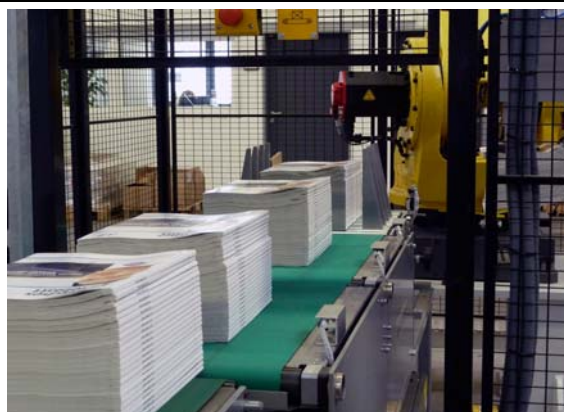
Il robot posiziona instancabilmente i pacchi uno dopo l'altro sulla linea di accumulo.
