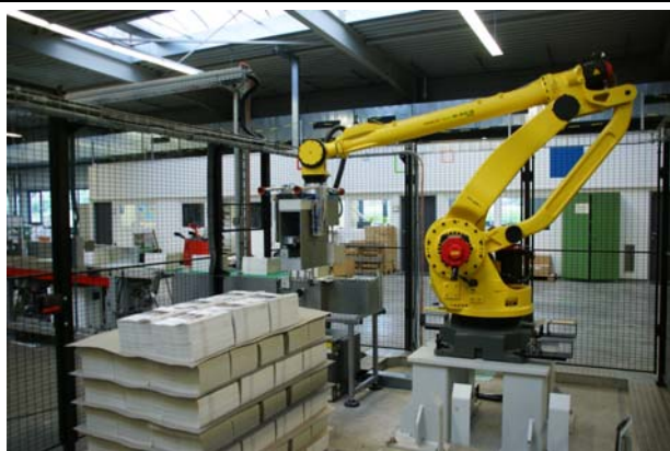
Il robot preleva i pacchi dal pallet e i sensori assicurano che nessun prodotto venga danneggiato.
